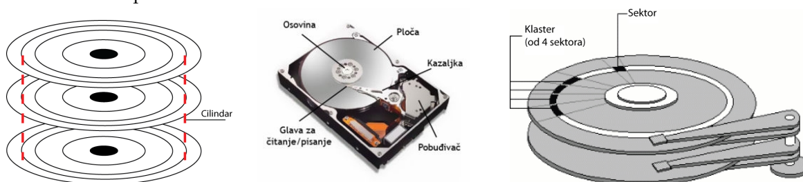
SLIKA 3.29: GLAVNI ELEMENTI HARD DISKA
